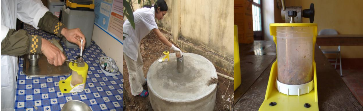
Hình 17. xử lý kim tiêm bằng máy cắt kim và chôn lấp sau cắt
